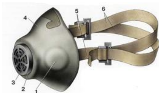
1 – клапан вдоха (2 шт.), 2 – экран, 3 – клапан выдоха, 4 - полумаска, 5 – эластичные тесёмки, 6 – нерастягивающиеся тесёмки
