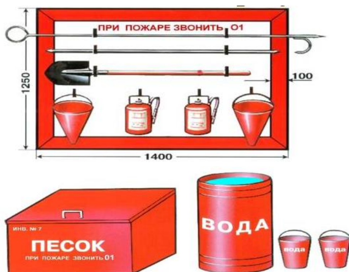
Рисунок 6 - Пожарный щит первичных средств пожаротушения
